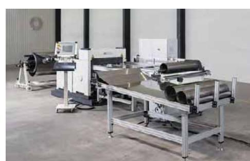
**Firma DALCOS** je výrobcom uceleného radu dierovacích liniek s odvýjaním zo zvitku a potrebného príslušenstva pre potreby zákazníkov a ich potrieb. Tieto linky sa vyznačujú precíznosťou, vysokou produkciou a pružnosťou pri potrebnej zmene výroby.
