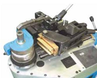
Sklučovací systém beztrňových ohýbačiek s hydraulickým upínaním trubky
