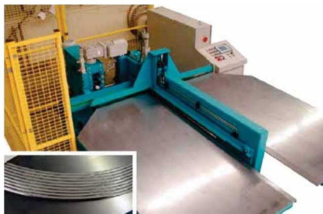
Vyobrazenie: Okružné nožnice na profilovanie prírub pre tesnenia až do priemeru Ø 2 000 mm.
