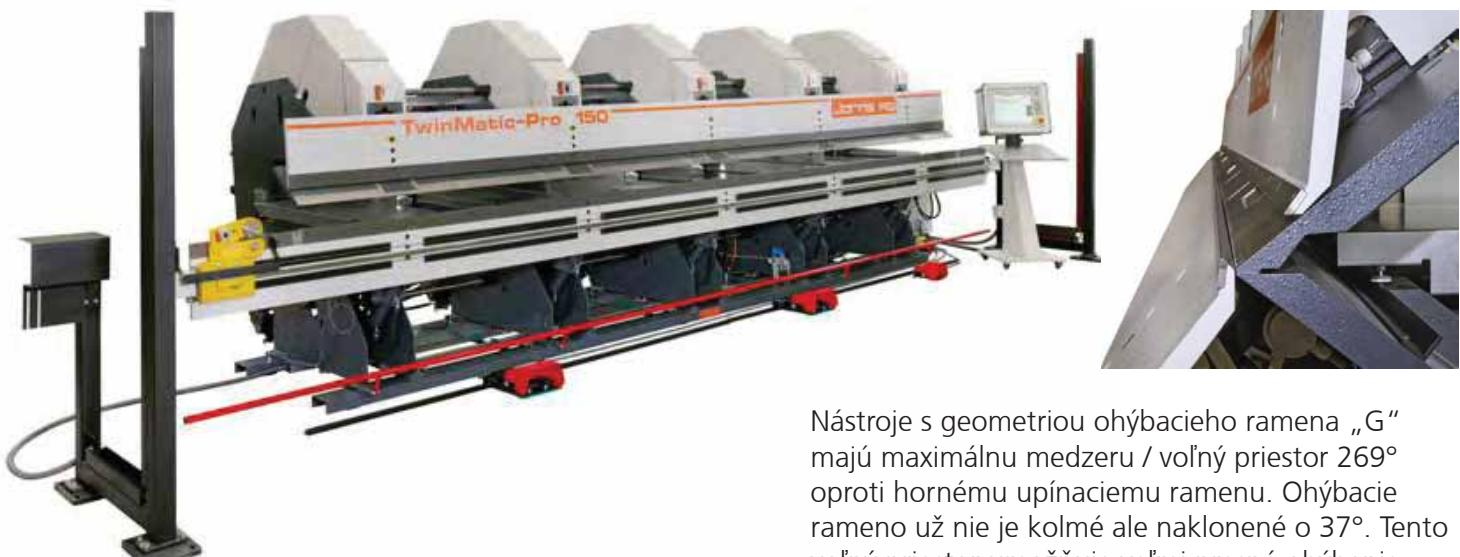
Nástroje s geometriou ohýbacieho ramena „G“ majú maximálnu medzeru / voľný priestor 269° oproti hornému upínaciemu ramenu. Ohýbacie rameno už nie je kolmé ale naklonené o 37°. Tento voľný priestor umožňuje veľmi presné ohýbanie presných 90°-ohybov a fasádnych profilov a trapézových profilov.
