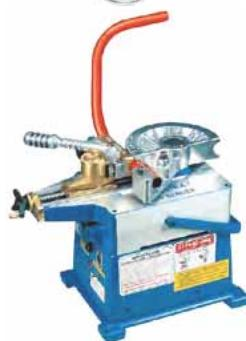
MEDIBENDER Prenosná ohýbačka s kapacitou ohýbania trubky do 48 x 3,5 mm.
