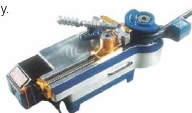
Najmenšia prenosná ohýbačka s kapacitou ohýbania Priemer X Hrúbka steny trubky do 27 x 2,3 mm.
