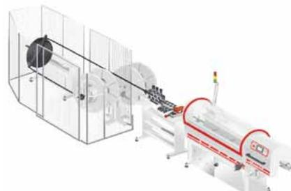
Priemyselné stroje typovej rady TCC slúžia na automatické bezrieskové odrezávanie rúr na presné dĺžky a následné formovanie koncov týchto rúr. Tvary ukončení a foriem sú buď štandardne používané alebo podľa želania zákazníka.
