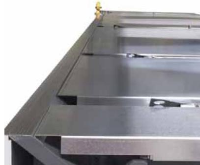
Adaptívne systémy zadného dorazu s variabilnými prstami so štandardnou hĺbkou dorazu 1250 mm. Špeciálny kónický prst, nezávisle polohovateľný po celej hĺbke dorazu zabezpečí ohýbanie kónických profilov a umožní vyrábať profily s funkciou spájania.
