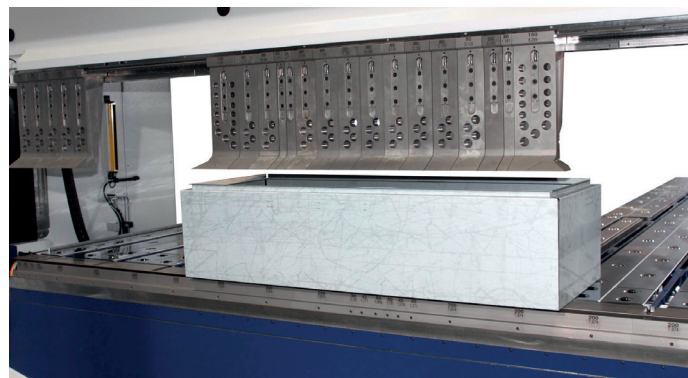
Ukážka špeciálneho ohýbania – nástroje o výške 400 mm, otvorenie ramena až do 800 mm – napríklad zatváranie panelov
