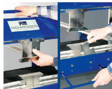
Patentované rýchlo-upínacie zariadenie nástrojov prítlačného ramena a ohýbacieho ramena s excentrom.
