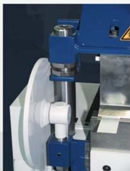
Prítlačné rameno vedené v kruhovom ráme vrátené nastavenia prítlaku horného ramena pre rozličné typy materiálov (hliník, prášková farba, perforovaný plech).
